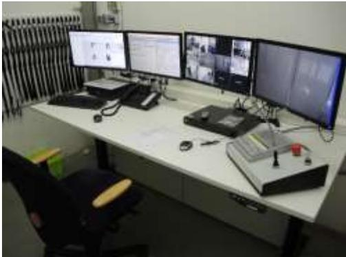
Vom Kontrollraum kann der Übungsverlauf gesteuert und überwacht werden. Die komplette Anlage ist Kameraüberwacht, was durch Infrarot- und Wärmebildkameras in jeder Situation gewährleistet ist. Jeder Teilnehmer erhält einen Transponder, mit dem er sich bei den Arbeitsgeräten und der Übungsstrecke an- und abmeldet. Bei der Registrierung wird die zu erbringende Leistung der einzelnen Geräte festgelegt.
